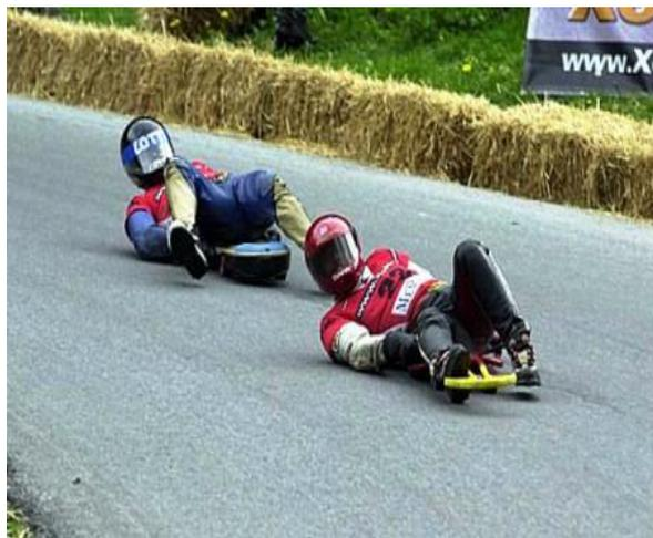
Este trineo monoplaça, con el que se han llegado a rebasar los 150 kilómetros por hora, está formado por un chasis de aluminio de entre 1,5 y 2 metros, ejes y ruedas. Su conductor, que permanece acostado sobre él durante el trayecto, aprovecha la fuerza y la inclinación de su cuerpo para guiarlo y las plantas de sus pies (que se suelen cubrir con una plancha de goma antiabrasión) para frenar esta particular medio de transporte.
